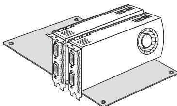
1 枚のグラフィックスカードを PCIE2 スロットに挿入して、もう 1 枚のグラフィックスカードを PCIE4 スロットに挿入します。カードがスロットに正しく収まっていることを確認してください。
