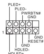
電源スイッチを接続し、スイッチをリセットし、下記のピン割り当てに従って、シャーシのシステムステータス表示ランプをこのヘッダーにセットします。ケーブルを接続するときには、ピンの十と一に気をつけてください。
